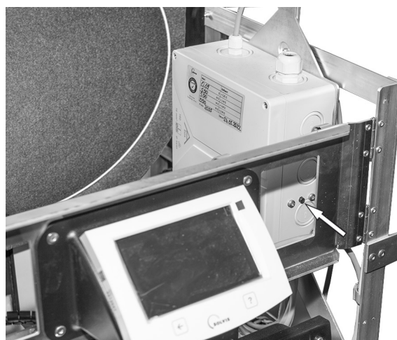
Afb. 147: Ontgrendelingsknop aansluitbox HPT
