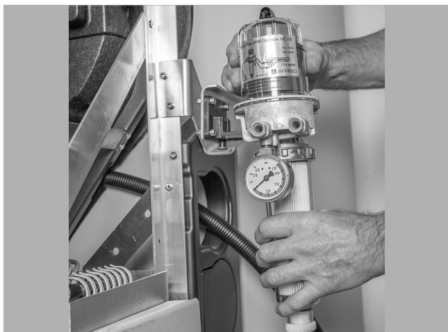
Afb. 65: Oliefilter erop steken
