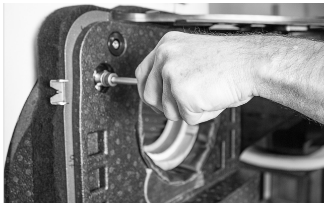
Afb. 14: Achterwand aanzuigkamer vastzetten
