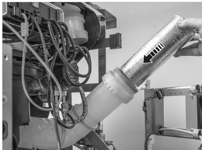
Afb. 79: Lange geluiddemper aan de onderkant erin zetten
