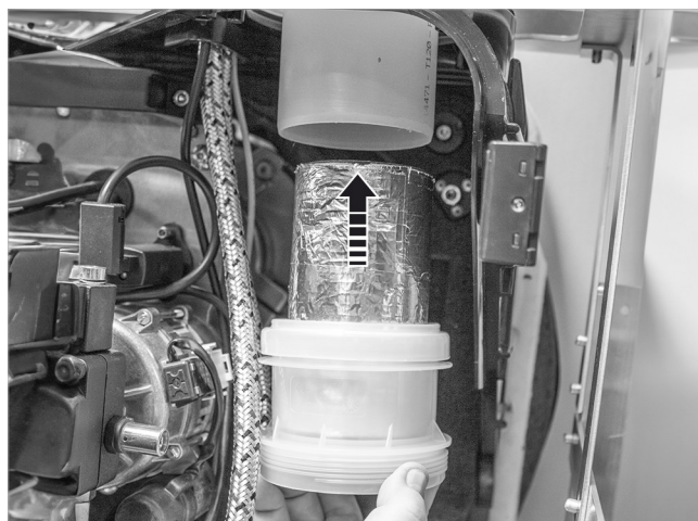
Afb. 78: Korte geluiddemper aan de bovenkant erin zetten
