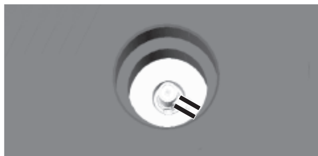
Fig. 141: Bleeder hose on the bleeder
