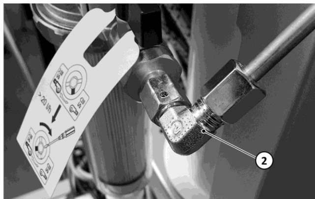
Fig. 73: Fissaggio della tubazione di alimentazione del gasolio al filtro
