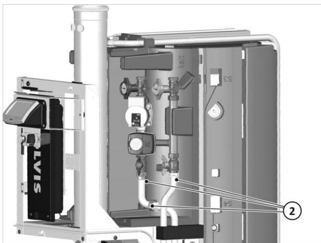
Fig. 34: Controllo / serraggio dei collegamenti angolari VL / RL
