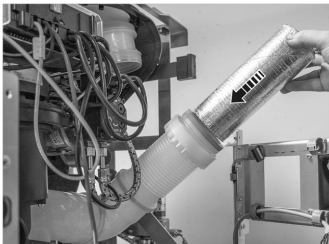
Fig. 82: Inserir il silenziatore lungo sotto
