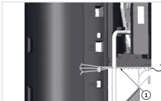
Fig. 22: Percorso del cablaggio dei sensori
