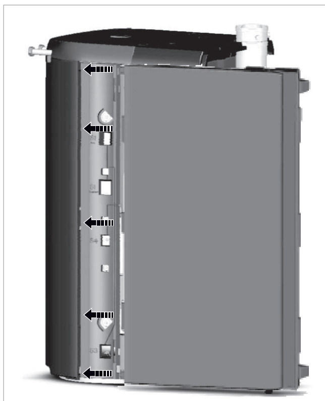
Fig. 135: Inserimento della parte laterale
