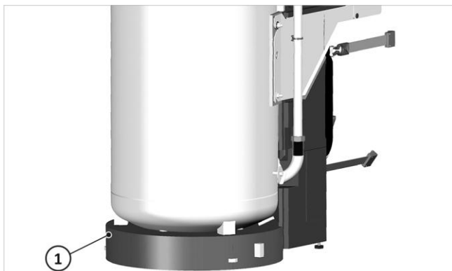
Fig. 15: Posa dello sviluppo circolare di base sotto l'accumulatore
