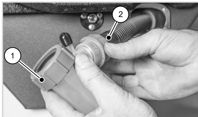
Fig. 86: Conexión del sifón de condensados a la manguera de condensados
