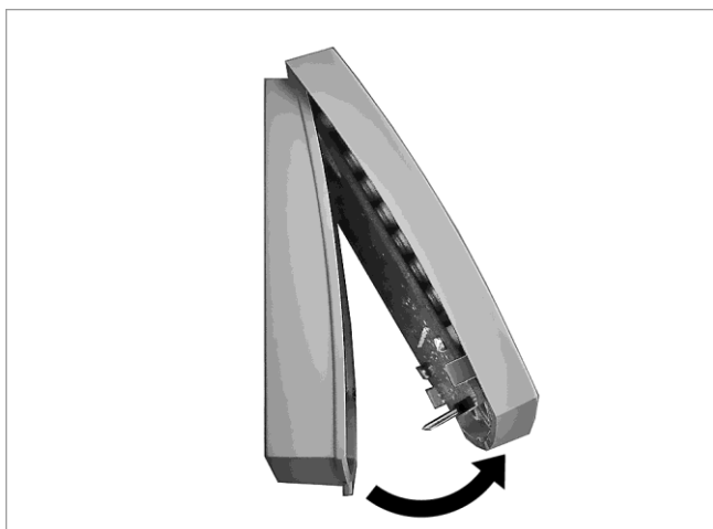
Fig. 110: Abrir la carcasa
