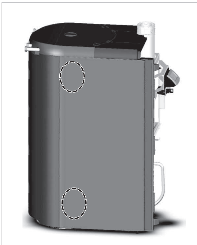
Fig. 136: Inserción de la pieza lateral
