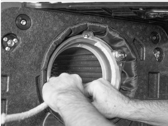
Fig. 48: Colocación del cordón de estanqueidad del quemador, junto a la 1 en punto
