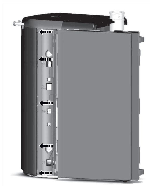
Fig. 135: Inserción de la pieza lateral
