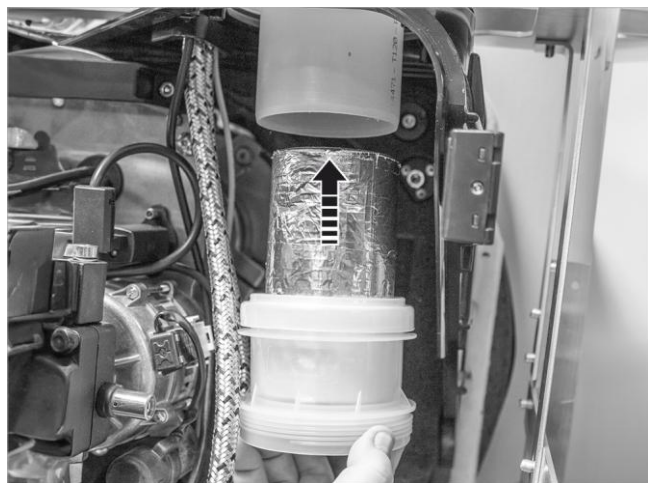
Fig. 81: Introducir el silenciador corto arriba
