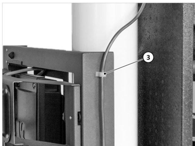
Afb. 74: Olietoevoerleiding op het frame bevestigen
