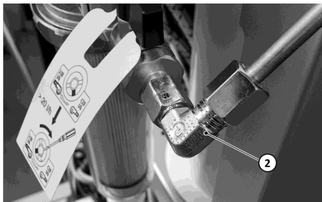
Afb. 73: Olietoevoerleiding op filter aansluiten
