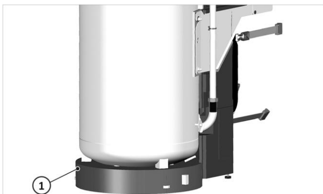
Afb. 15: Rond vloerdeel onder de boiler leggen
