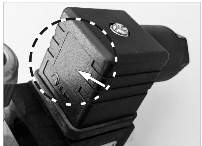
Abb. 4: Magnetventil - kein Symbol auf dem Stecker für Wechselstromspule
