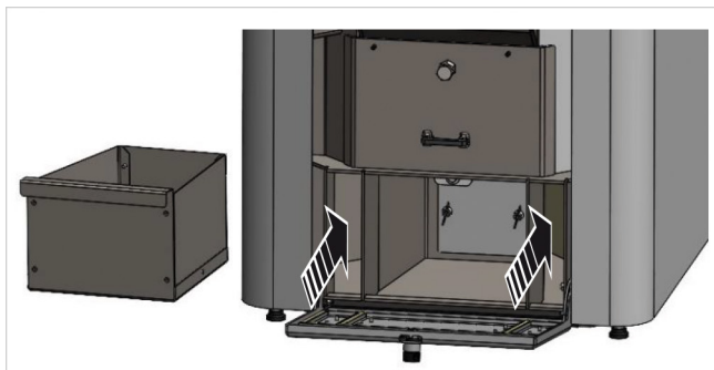
Abb. 24: Seitliche Querzüge reinigen
