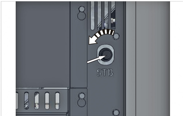
Abb. 28: Sicherheitstemperaturbegrenzer an SolvisBruno zurücksetzen
