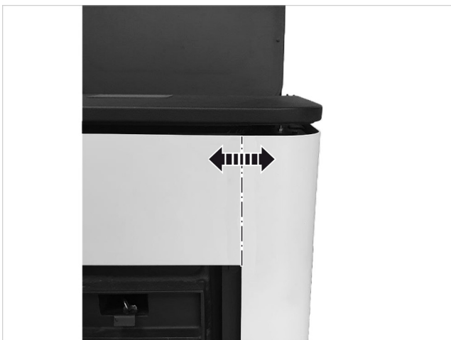
Abb. 12: Gleichmäßige Spaltmaße der Verkleidung von SolvisBruno einstellen
