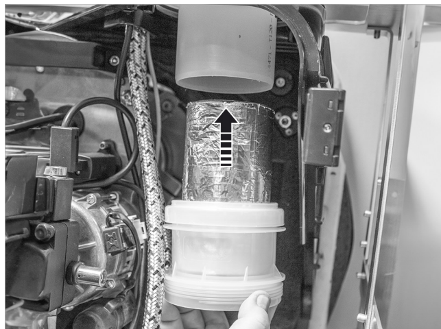
Abb. 78: Kurzen Schalldämpfer oben einsetzen
