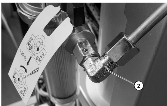
Abb. 73: Ölzuleitung am Filter anschließen
