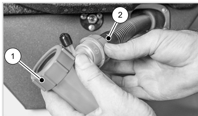
Abb. 86: Kondensatsiphon an Kondensatschlauch anschließen
