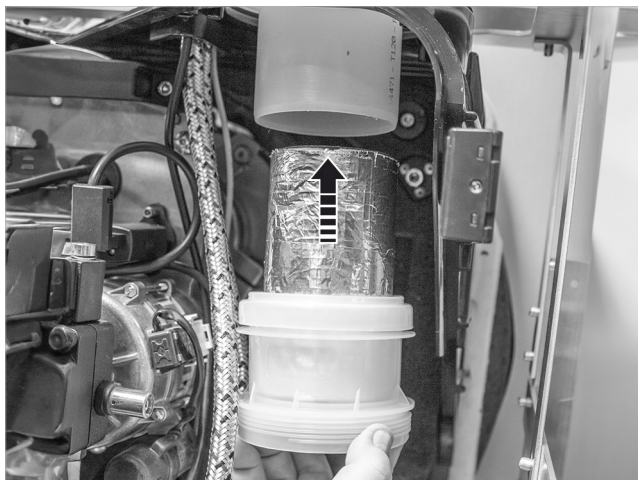
Abb. 81: Kurzen Schalldämpfer oben einsetzen
