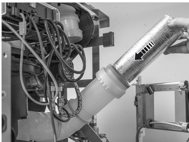
Abb. 82: Langen Schalldämpfer unten einsetzen
