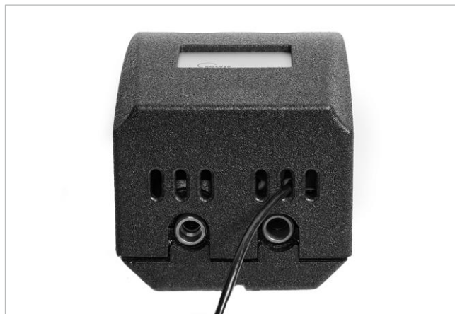
Abb. 8: Modbus-Leitung durch Lüftungsschlitz geführt
