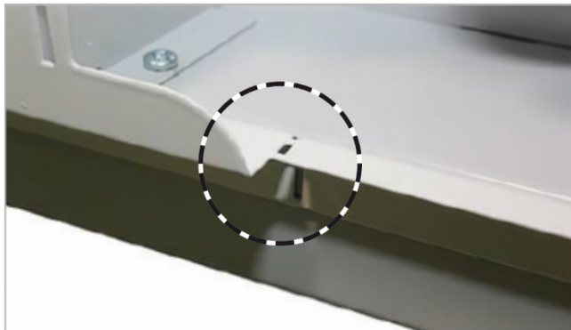
Abb. 4: Ausbrechkante an der hinteren Abdeckung
