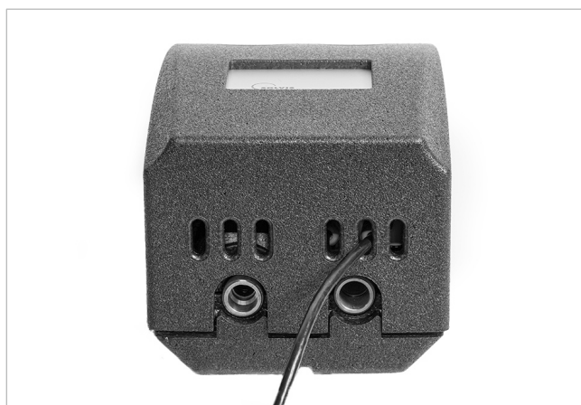
Fig. 9: Passaggio del cavo Modbus attraverso la fessura di ventilazione
