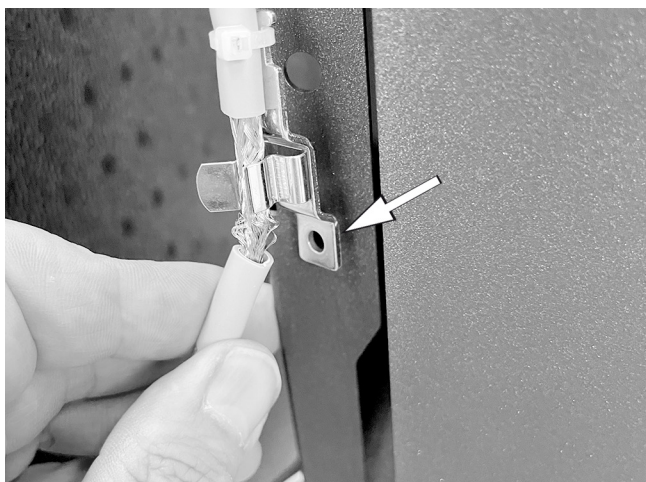
Fig. 6: Fissare il morsetto dello schermo allo sportello della scheda di rete SolvisBen
