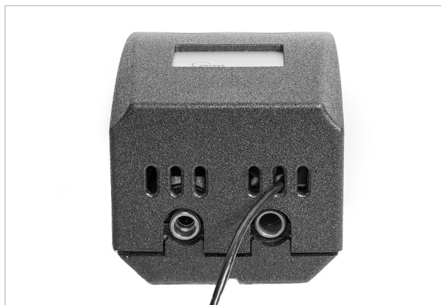
Fig. 9: Cable Modbus guiado a través de la ranura de ventilación
