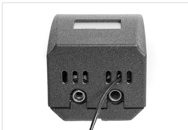
Afb. 9: Modbuskabel geleid door ventilatiesleuf
