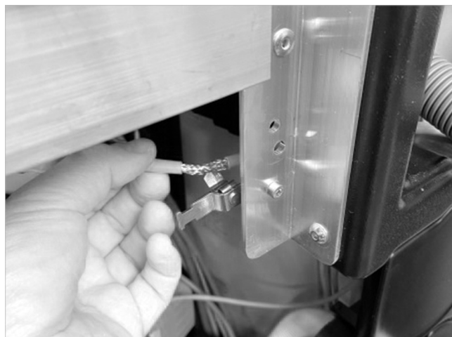
Abb. 17: Schirmklemme am Gestell des Lademoduls von SolvisMax
