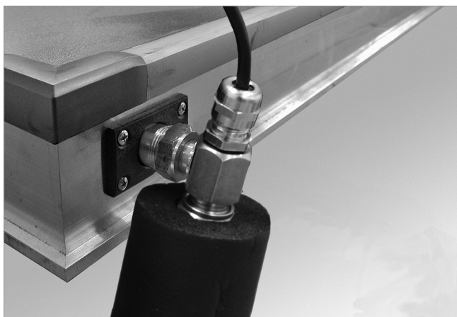
Abb. 92: Sensor montieren (Solar-Vorlauf)
