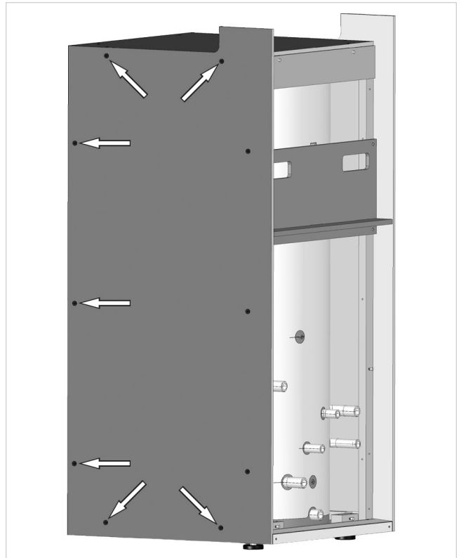
Abb. 8: Holzverkleidung links demontieren
