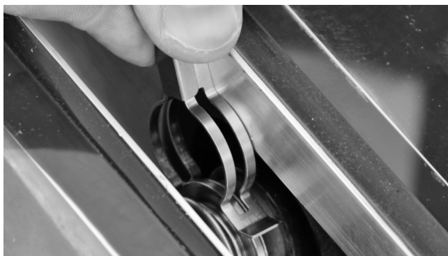
Fig. 23: Insertar clip de seguridad
