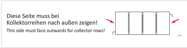
Fig. 10: Nota sobre el lado largo del colector orientado hacia el exterior
