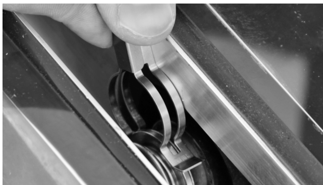
Fig. 46: Insertar clip de seguridad
