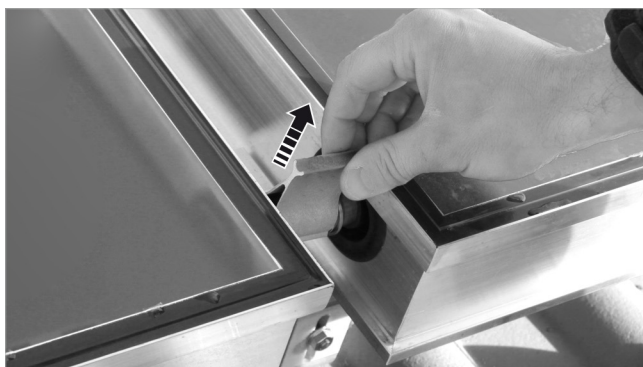
Fig. 22: Retirar manguito distanciador
