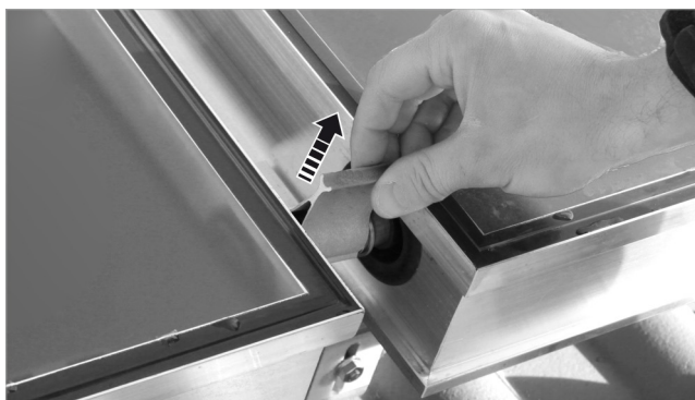
Fig. 22: Verwijder de afstandsstukken
