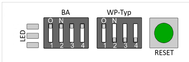
Abb. 52: Einstellung der DIP-Schalter auf IWS
